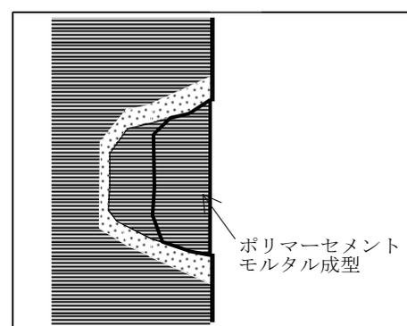
① 欠損部深さ 50mm 以上の場合のアンカー処理
